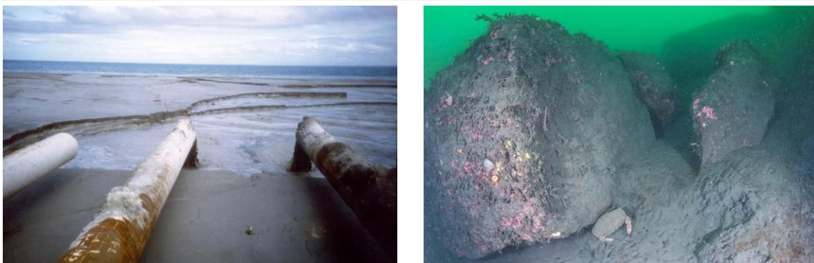
Figure 40 : Déversements réalisés en milieux marins ; à gauche : Déversement de résidus miniers dans la baie de Calancan, mine d'or de Marcopper, Philippines<sup>120</sup> (© Catherine Coumans, MiningWatch Canada · [Lien flickr](#)) ; à droite : Lit du Jøssingfjord recouvert de résidus miniers, 35 années après l'arrêt de cette pratique, mine de titane de Tellnes<sup>120</sup>, Norvège (© Erling Svensen, Earthworks · [Lien flickr](#))
