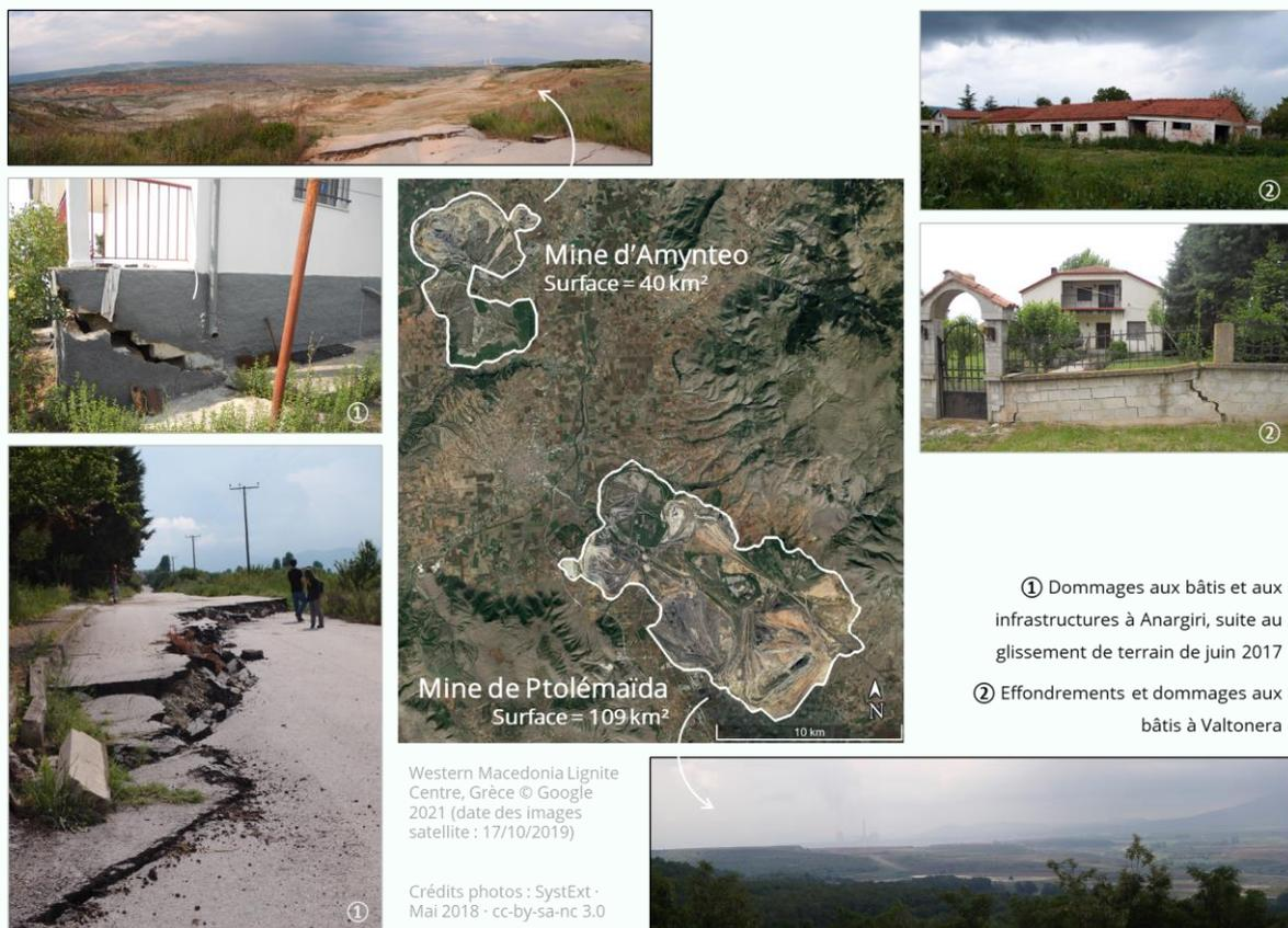
Figure 31 : Situation du bassin *Western Macedonia Lignite Centre*, Grèce ; effondrements, dommages aux bâtis et aux infrastructures (Création : SystExt · Octobre 2021 ; photographies : SystExt · Mai 2018 · cc by-sa-nc 3.0)
