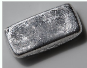
Figure 54 : (à gauche) Sphalérite, minerai de zinc (contenant notamment de l'indium) du district minier de Tri-State, États-Unis | Missouri Department of Natural Resources · Lien - (à droite) Lingot d'indium de 40 grammes (dimensions de 2 x 4,5 cm) | cc by 3.0 deed · Lien
