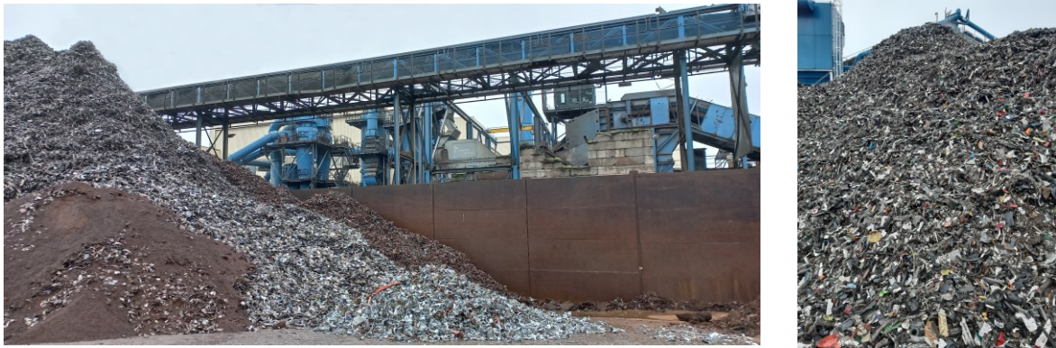
Figure 27 : Installation de broyage de véhicules hors d'usage (VHU) et de déchets d'équipements électriques et électroniques (DEEE) (adapté) et matériaux broyés associés · Site de prétraitement d'Obourg, Mons, Belgique, groupe COMET | SystExt · octobre 2023 · cc by-nc-sa 4.0 deed
