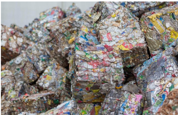
Déchets ménagers • Balles de déchets de canettes d'aluminium | © MTB Group, mise à disposition gracieuse à SystExt
