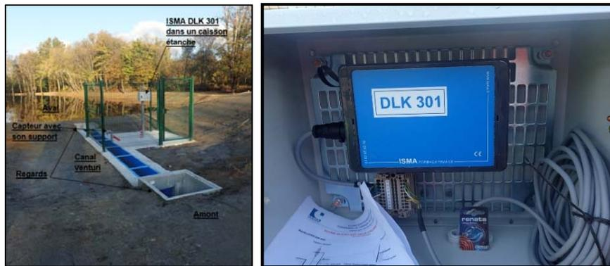
Illustration 31 : Canal venturi et débitmètre dans le caisson étanche.
