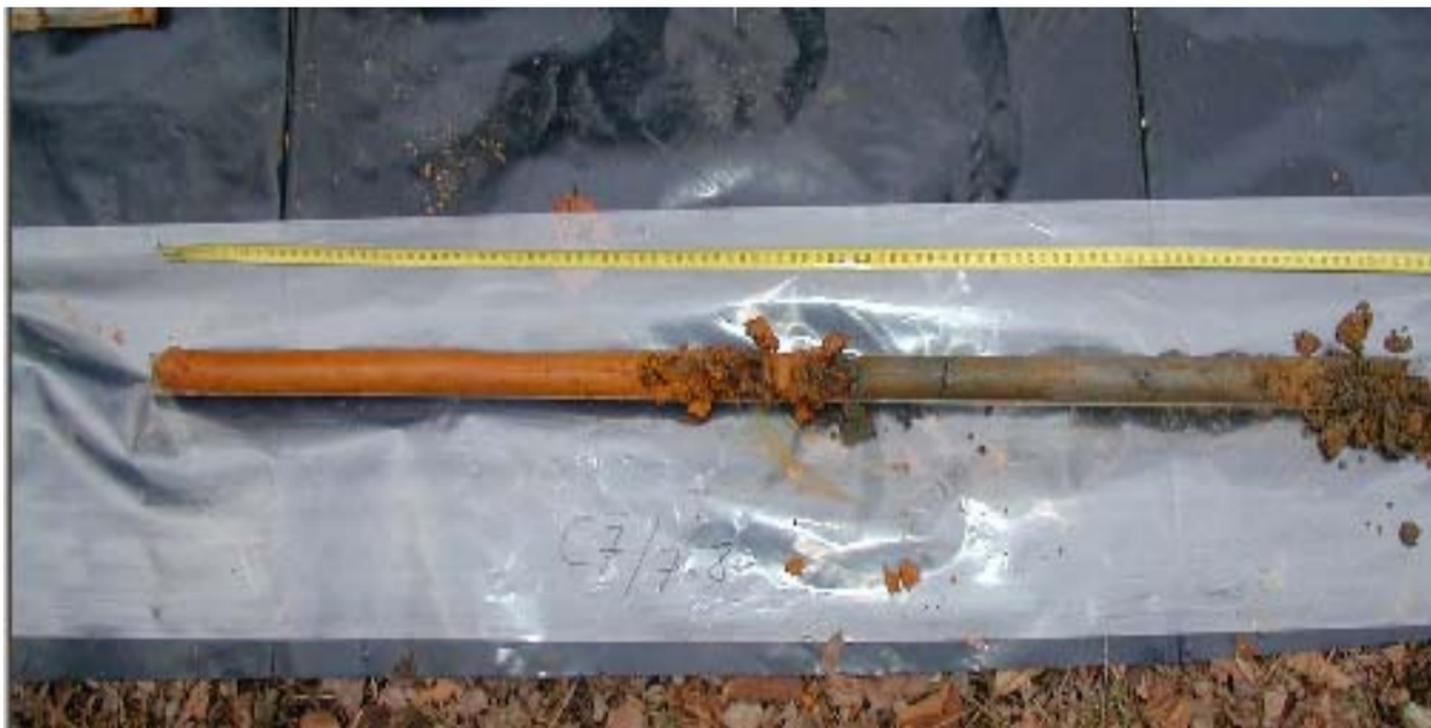
*Fig. 15 - Carotte montrant le passage résidus-argile formant la base des tas.*
