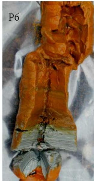
*Fig. 27 - Stratigraphie des carottes de sédiments de décantation (bassin n° 1).*
