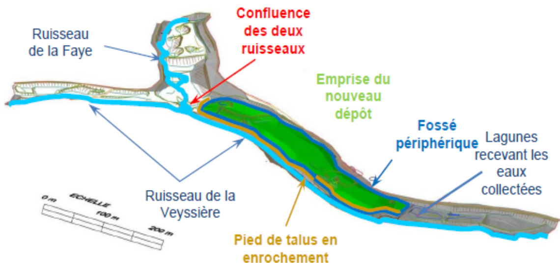
Figure 5 : site de Roure-les-Rosiers après travaux (source : dossier de demande d'autorisation p. 8)
