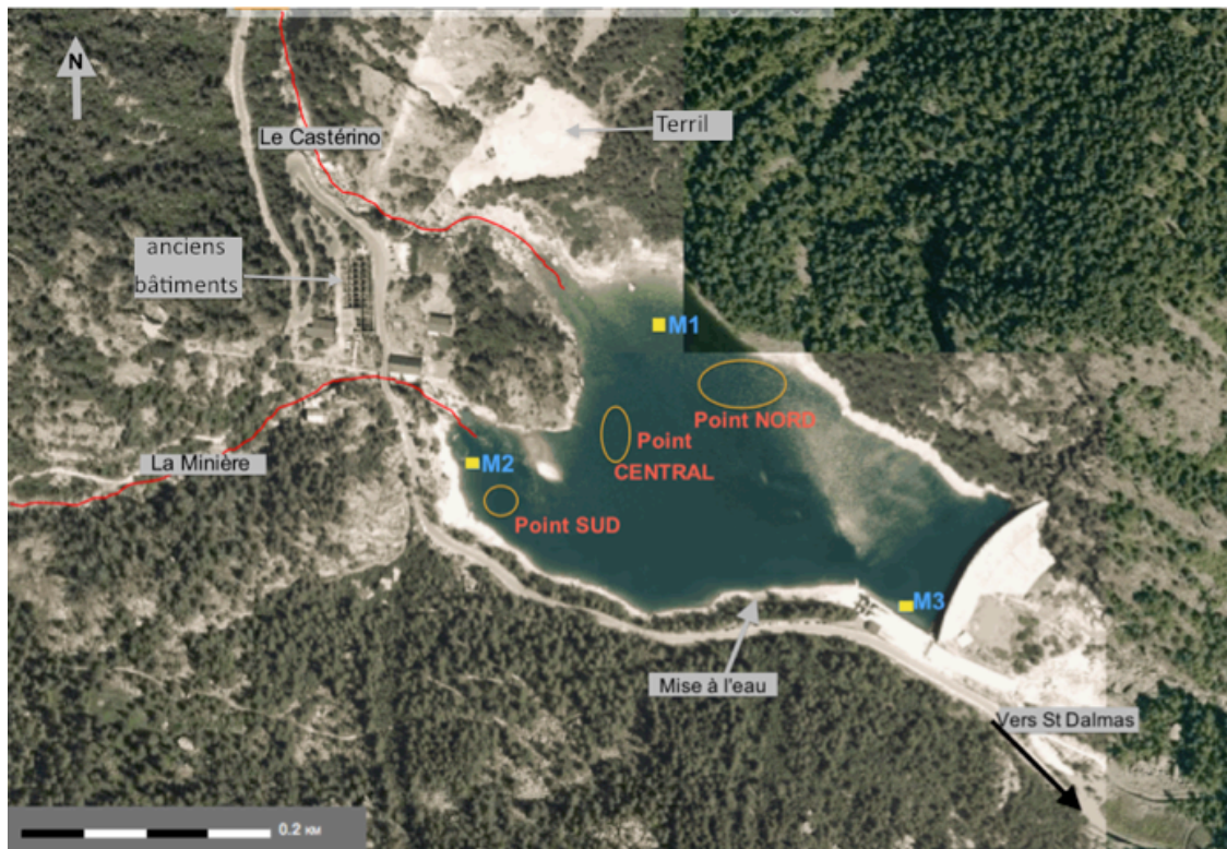
Figure III-2: Localisation des zones de prélèvement des sédiments dans la retenue des Mesches en juin 2015 (Point Nord, Central et Sud). Les points M1, M2, M3 ont été analysés dans l'étude d'impact de la vidange réalisée par EDF en 2007.
