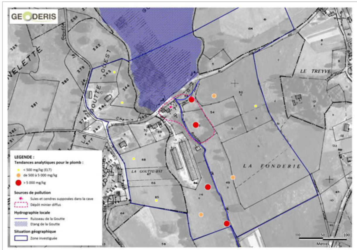
Figure 20 : Tendances analytiques obtenues pour le plomb dans les prélèvements de sols de prairies sur le site de la fonderie de la Goutte, sur fond orthophotoplan © IGN et BD Parcellaire © IGN
