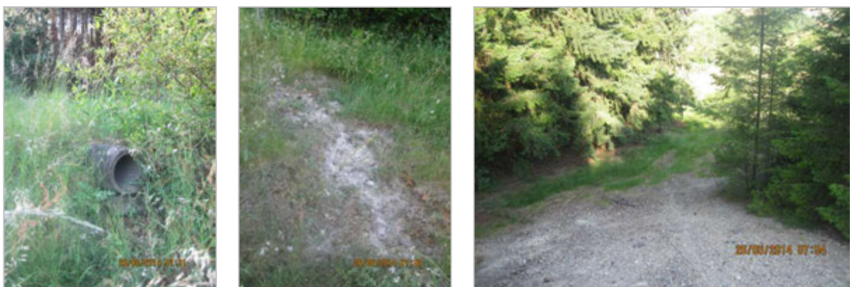
Figure 30 : Ruissellement le long du dépôt 42-0069-C-T3 et entraînement de matériaux résiduaire vers le centre de la prairie située en aval (INERIS, 2015)
