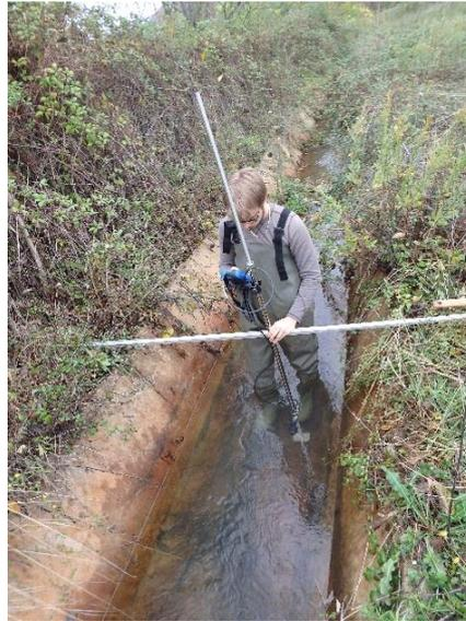
Illustration 40 - TB 250 - Jaugeage dans le canal d'évacuation – Le Bousquet-d'Orb (34).
