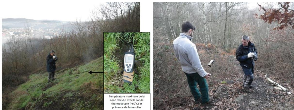
*Illustration 84 - Terril Lacaze à Decazeville - Inspection par caméra thermique et sonde thermocouple (janvier 2016).*
