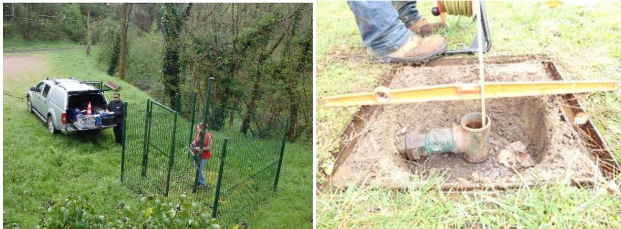
*Illustration 88 - Exécutoires « gaz » - Mesures « gaz » sur le sondage de décompression la Buenhe à Aubin (à gauche) et mesure piézométrique dans puits de mine Puits 1 Ancien à Cransac (à droite).*
