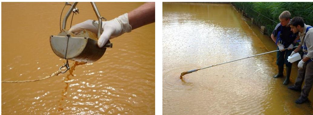
Illustration 17 - Station de Destival - Prélèvement de boue dans le décanteur - à gauche : mini benne preneuse - à droite : tarière à ampoule échantillonneuse - Saint-Martin-de-Valgalgues (30).
