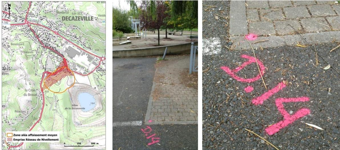
*Illustration 130 - Mine de fer de Lagrange à Decazeville (12) : mise en place du réseau de nivellement - localisation de la zone concernée (à gauche) pré-marquage de l'emplacement du repère de nivellement DECAZ 14 et son « clou d'arpentage » (au centre et à droite).*
