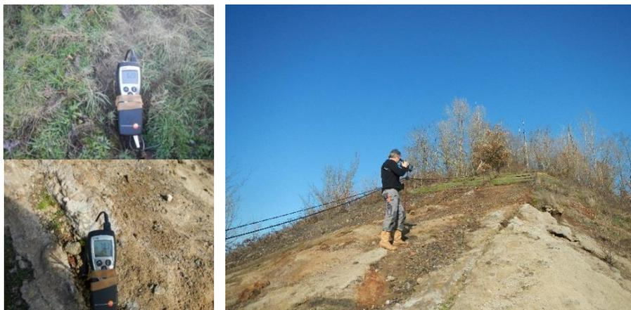
Illustration 96 - Terrils de l'Aérien et de Lacaze à Decazeville - Mesures par la sonde thermocouple (à gauche) et inspection par caméra thermique (à droite) en janvier 2017.
