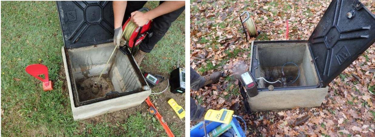
*Illustration 93 : Exutoires « gaz » - Mesure piézométrique (à gauche – prise de vue août 2019) et mesure des « gaz » dans le sondage de décompression La Lunelle à Aubin (à droite – prise de vue décembre 2019).*
