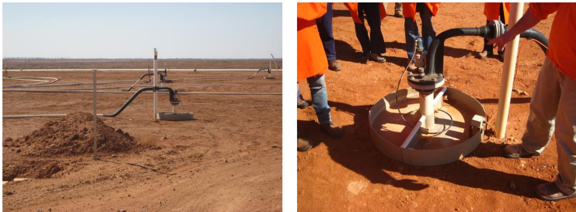
Figure 37 : Mine d'uranium de Beverley, Australie, exploitée par lixiviation in situ ; à gauche : champs de puits, à droite : puits injecteur | brotherlywalks · Mai 2009 · cc by-nc-nd 2.0
