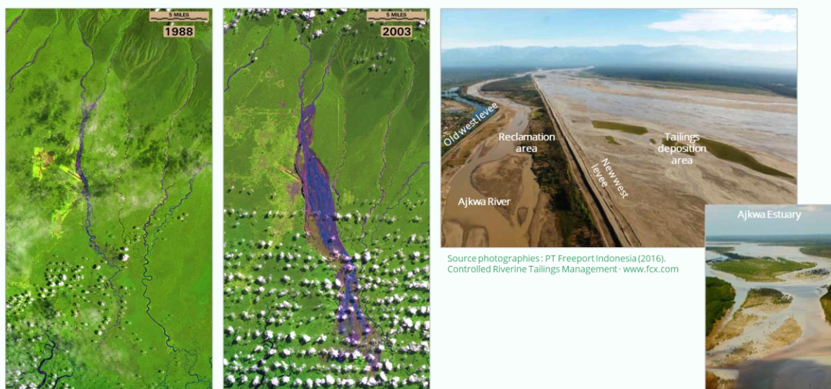
Figure 47 : Impacts des déversements de résidus miniers dans la rivière Ajkwa, située en aval du site minier de Grasberg, Indonésie (à gauche) Images satellites Landsat montrant le réseau hydrographique en 1988 (environ 5 ans après le début des déversements) et en 2003 (échelle : 5 miles = 8 km) | SkyTruth · cc by-sa-nc 2.0 (à droite) Rivière Ajkwa et son estuaire recouvert de résidus miniers ; tiré de (PT Freeport Indonesia, 2016)
