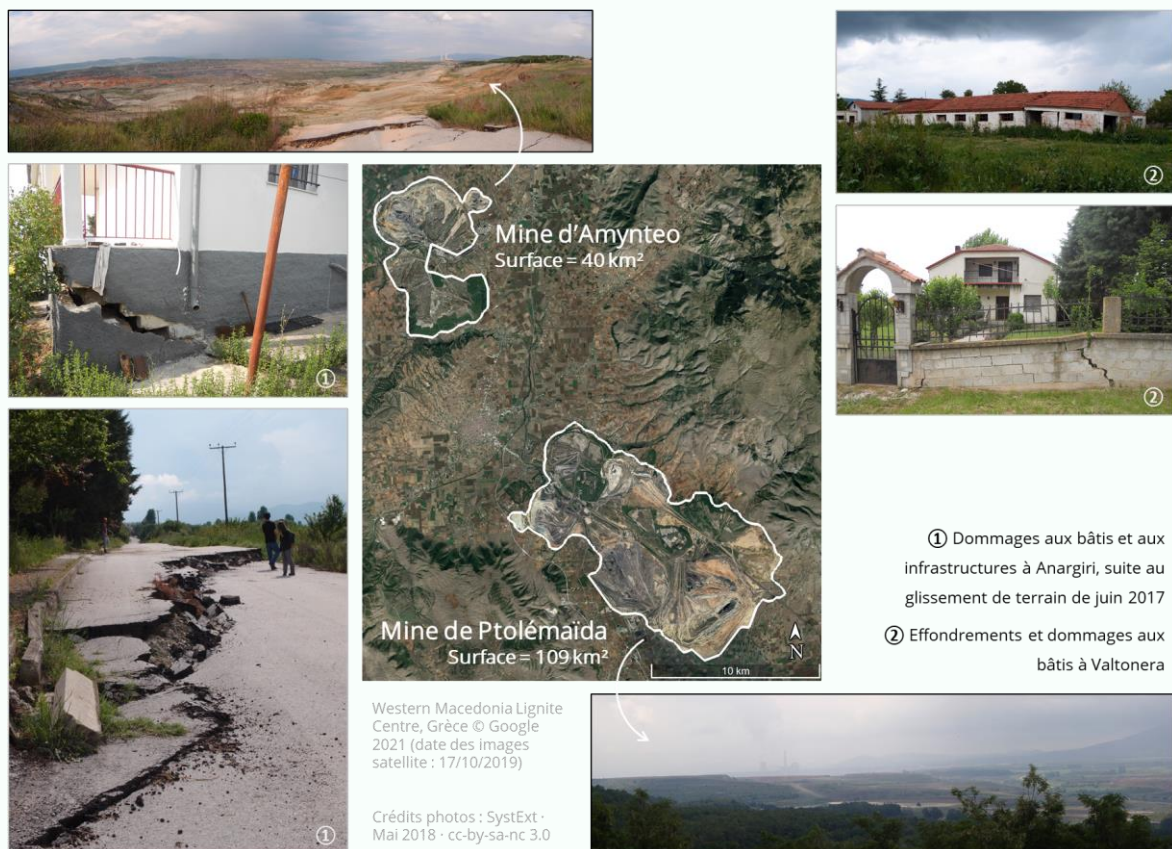
Figure 31 : Situation du bassin Western Macedonia Lignite Centre , Grèce ; effondrements, dommages aux bâtis et aux infrastructures | Création : SystExt · Octobre 2021 ; photographies : SystExt · Mai 2018 · cc by-sa-nc 3.0
