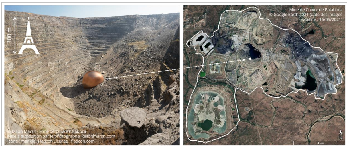
Figure 9 : Mine de cuivre de Palabora, Afrique du Sud ; (à gauche) Représentation imagée de la quantité de cuivre métal produite jusqu'à environ 2007 (© Dillon Marsh · Mise à disposition par le photographe · dillonmarsh.com ) ; à droite : Vue satellitaire de la mine et mise en évidence de l'emprise en surface des déchets miniers et des installations minières (© Google 2021) | Création : SystExt · Septembre 2021
