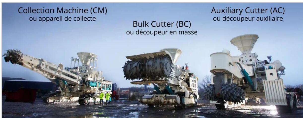
Figure 8 : Véhicules sous-marins télécommandés qui devaient être déployés dans le cadre du projet Solwara 1 ; adapté de © Mike Smith Photography & Motion dans (Watts, 27/09/2021, *The Guardian*)
