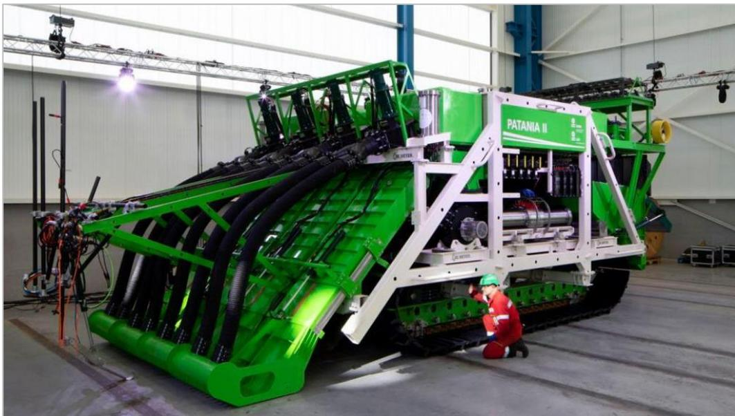
Figure 10 : Véhicule sous-marin télécommandé expérimental de collecte des nodules « Patania II » ; tiré de ([DSM Observer, 2018](#))
