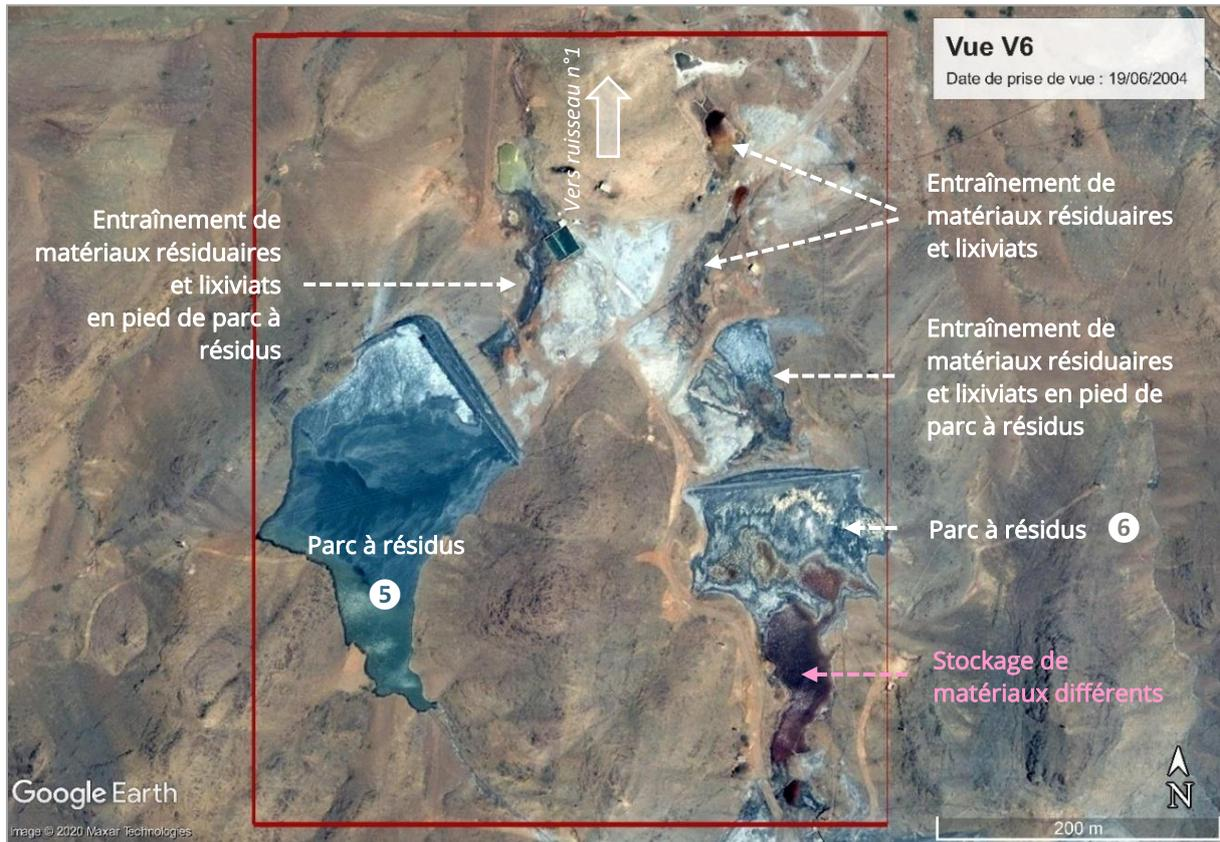
Figure 23 : Vue satellitaire historique (en date du 19/06/2004) mettant en évidence des phénomènes supposés d'entraînement de matériaux résiduels et d'écoulement de lixiviats (© Google)<sup>52</sup>
